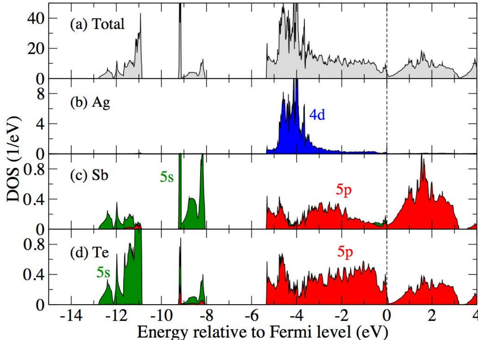
価電子帯のトップが反結合状態→金属イオンの原子空孔
