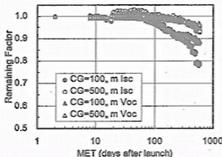
(d) InGaP/GaAs タンデム 2 接合太陽電池
