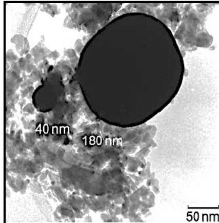
$\text{Al}_2\text{O}_3$  坦持では焼結のため、触媒機能が消失
