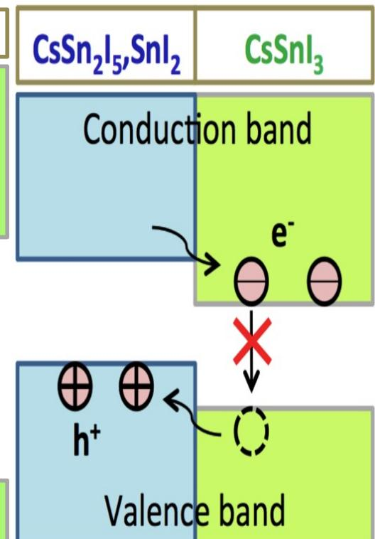
■非平衡状態の結晶成長: → スピノナル・ナノ分解 (e<sup>-</sup>とh<sup>+</sup>の高速分離)
