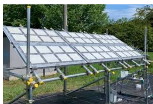
3m 2 規模の光触媒パネル反応器（左）と100m 2 規模の光触媒パネル反応器から生成した水素と酸素の混合気体（右）
