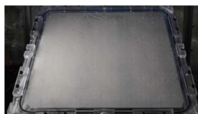
光触媒パネル反応器の基本単位（左）と紫外光照射時の水分解反応時の様子（右）
