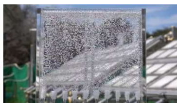
3m 2 規模の光触媒パネル反応器（左）と100m 2 規模の光触媒パネル反応器から生成した水素と酸素の混合気体（右）
